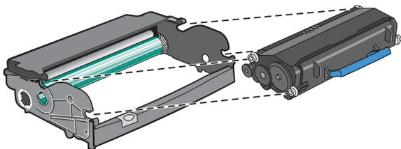
6 Setzen Sie die Einheit wieder in den Drucker ein, indem Sie die Pfeile auf den Führungen der Einheit auf die Pfeile im Drucker ausrichten. Schieben Sie die Einheit so weit wie möglich in den Drucker.
