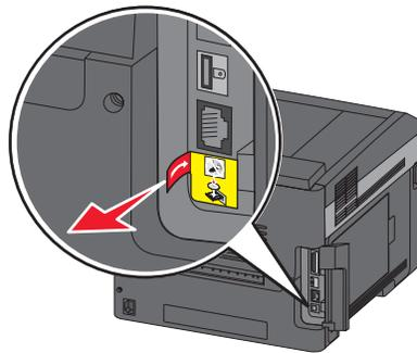
**8** Schließen Sie das USB-Kabel vorübergehend an den Computer im WLAN-Netzwerk und den Drucker an.
