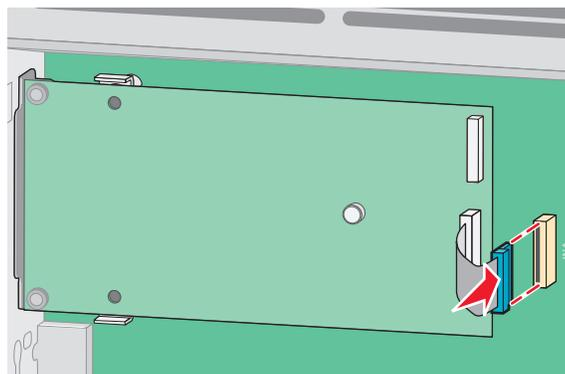
**12** Wenn bereits eine Druckerfestplatte installiert wurde, schließen Sie sie am ISP an. Weitere Informationen finden Sie unter "Installieren einer Festplatte" auf Seite 32.
