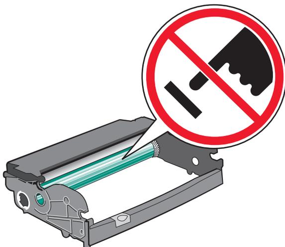
5 Setzen Sie die neue Druckkassette in das Fotoleiter-Kit ein, indem Sie die Rollen der Druckkassette auf die Schienen des Fotoleiter-Kits ausrichten. Schieben Sie die Druckkassette so ein, dass sie hörbar einrastet.
