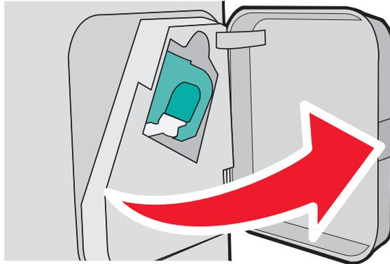
2 Drücken Sie die Verriegelung der Heftklammerhalter nach unten, und ziehen Sie den Halter aus dem Drucker.
