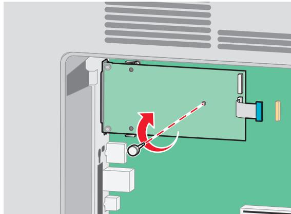
**9** Befestigen Sie die ISP-Halterung mit den beiden mitgelieferten Schrauben am Systemplattenrahmen.
