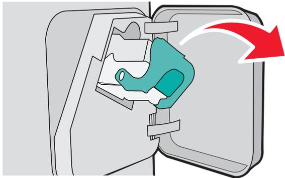
3 Heben Sie den Heftklammerschutz mit Hilfe der Metalltasche hoch, und entfernen Sie anschließend alle losen Heftklammern.
